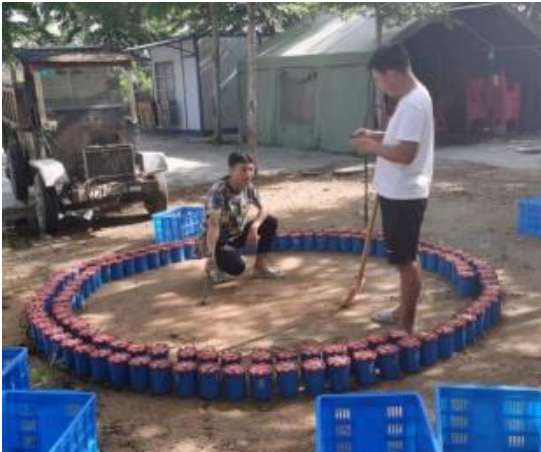
图 4.3-4 仪器一致性试验
