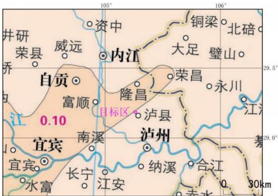
图 0.1-2 目标区位于中国地震动参数区划图(GB18306-2015)示意图
