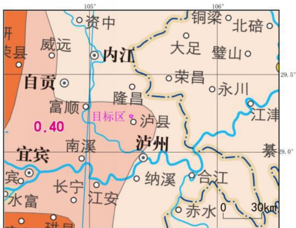
图 0.1-3 目标区位于中国地震动参数区划图(GB18306-2015)示意图
